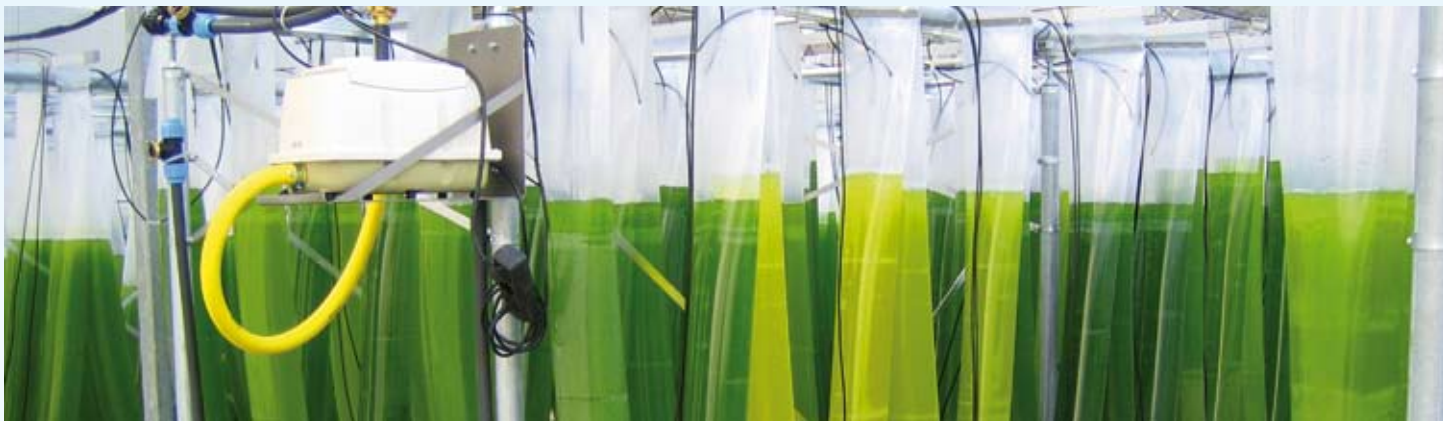
Bild 3: Anordnung der Photobioreaktoren im Gewächshaus.
